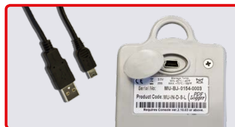
Cavo di collegamento USB fornito con i Logger MiniPlus PDF
